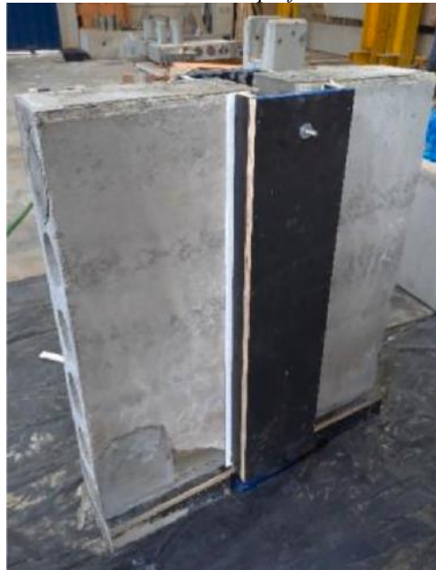
Figura 2.23: Investigação experimental do piso misto de pequena altura com laje alveolar e apenas uma abertura no perfil
