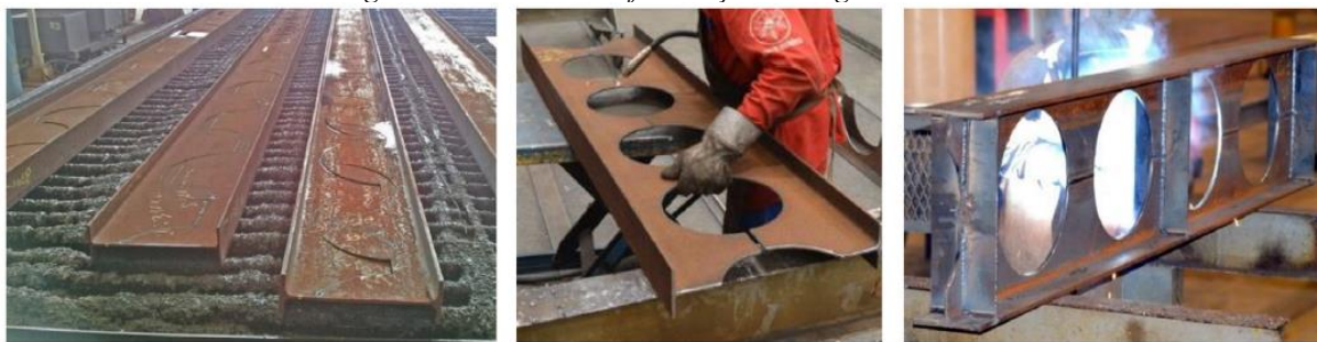
Figura 2.2: Processo de fabricação das vigas celulares
