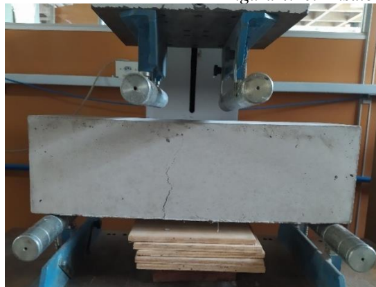
(a) Concreto reforçado com fibras
