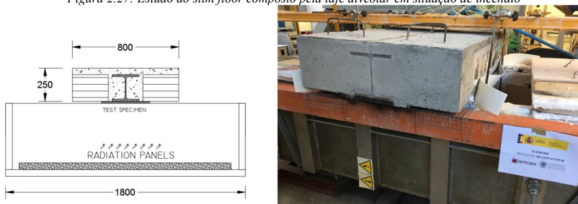
Figura 2.27: Estudo do slim floor composto pela laje alveolar em situação de incêndio
