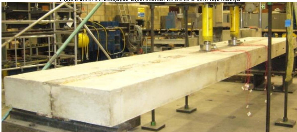
Figura 2.18: Investigação experimental do SCCFB com laje maciça
