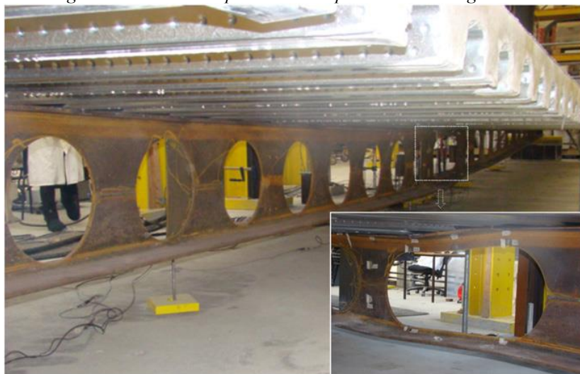
Figura 2.12: Estudo experimental do piso misto com viga celular
