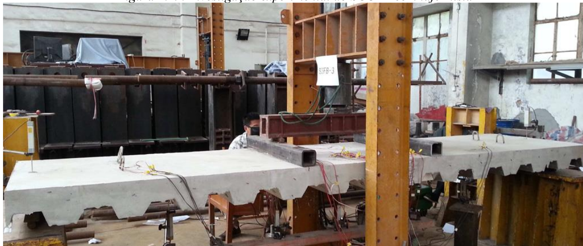
Figura 2.19: Investigação experimental do SCCFB com laje mista
