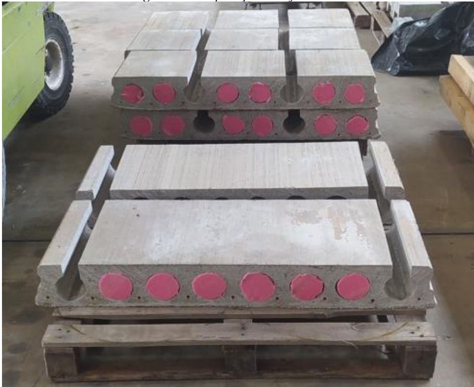
Figura 4.7: Preparação da laje alveolar
